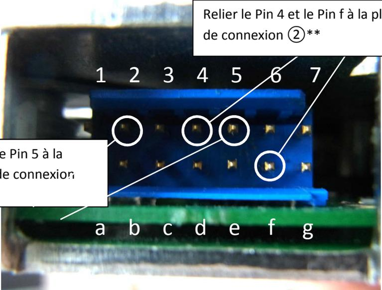
Relier le Pin 4 et le Pin f à la plaque à bornes de connexion ②\*\*
