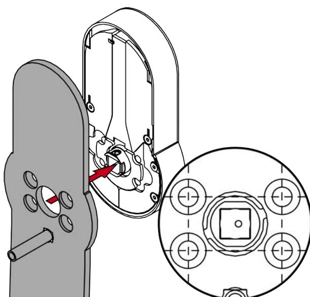
9. Alignez les trous de la plaque d'adaptation avec les filetages de la ferrure.
