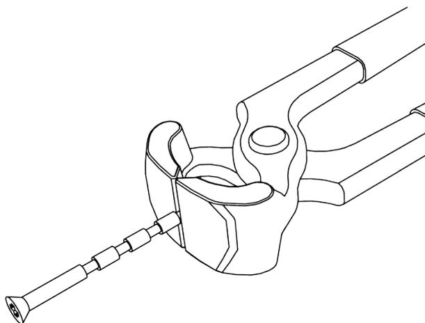
5. Pour carré de 7 mm : Placez la douille d'adaptation dans le logement carré de la béquille intérieure de manière à ce que l'évidement soit orienté vers la vis sans tête.
