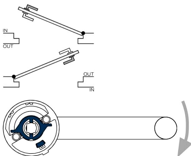
6. Insérez la plaquette adaptable dans la béquille intérieure.
