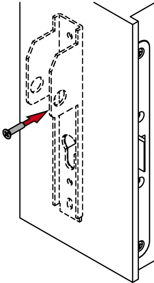
11. Vissez également la plaque d'adaptation sous le trou de serrure (PH2, couple : 1,1 Nm).
