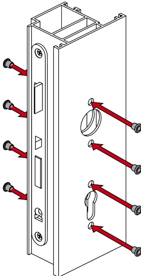
2. Vissez la plaque de montage à l'extérieur de manière à ce que les clips à ressort soient orientés vers la porte (PH2, couple : 1,1 Nm).
