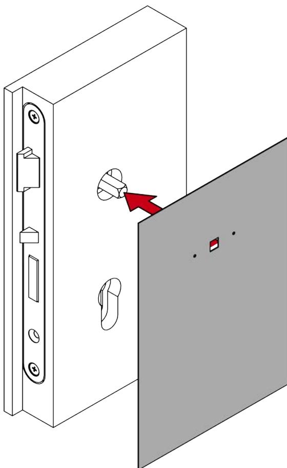
3. Alignez le gabarit de perçage verticalement à l'aide de l'échelle imprimée.
