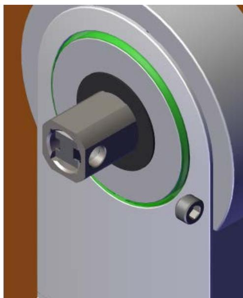
6. Enfichez la béquille extérieure FSB avec la vis sans tête prémontée sur l'adaptateur.
