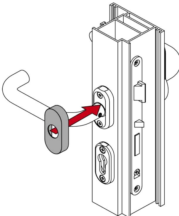
26. Insérez une blinde avec l'encoche vers le bas sur la base de la rosace.
