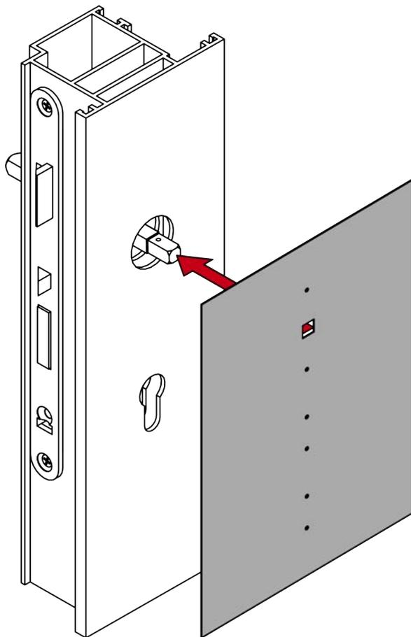
3. Alignez le gabarit de perçage verticalement à l'aide de l'échelle imprimée.
