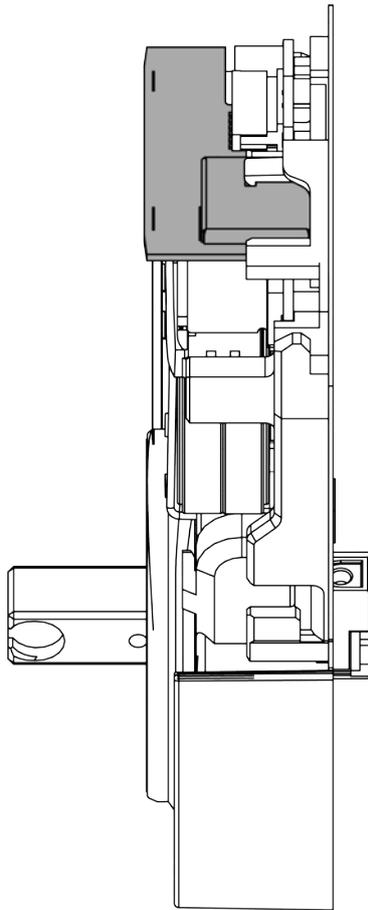
4. Insérez le coin du bras sous la bague en plastique transparente.
