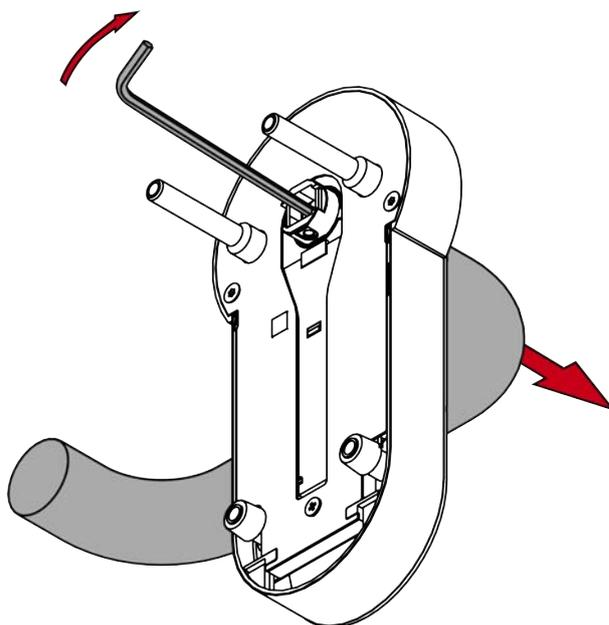
↳ La SI.SmartHandle AX est démontée.
