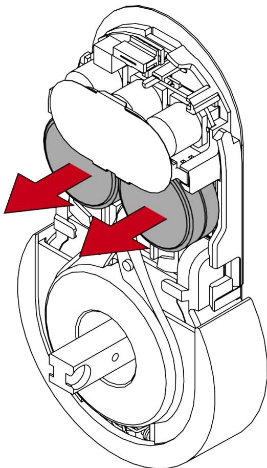
7. Mettez les piles neuves en place avec les pôles positifs en contact (type CR2450).
