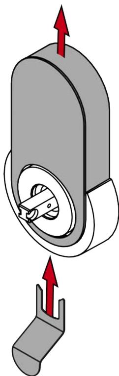
17. Pour carré de 7 mm : Insérez la douille d'adaptation sur le carré.
