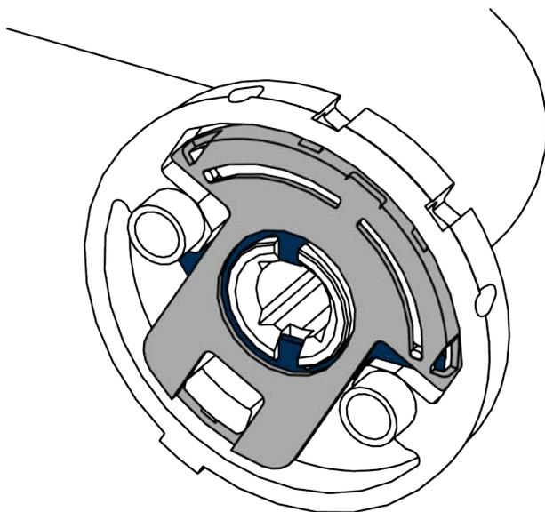
10. Pour carré de 7 mm : Insérez la douille d'adaptation sur le côté du carré avec broche.
