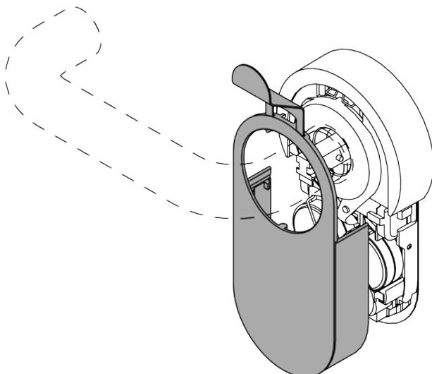
3. Pliez délicatement le clip de la pile vers l'intérieur pour le décrocher.
