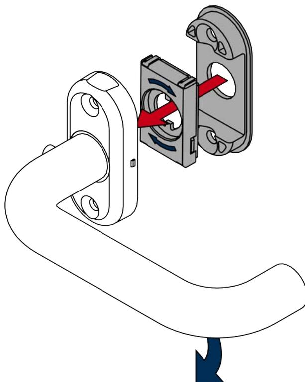
14. Pour carrés de 8,5 mm et 10 mm : Faites glisser la douille de l'adaptateur au centre du carré. À l'aide d'un pointeau et d'un marteau, faites un creux dans la douille de l'adaptateur pour l'empêcher de glisser.
