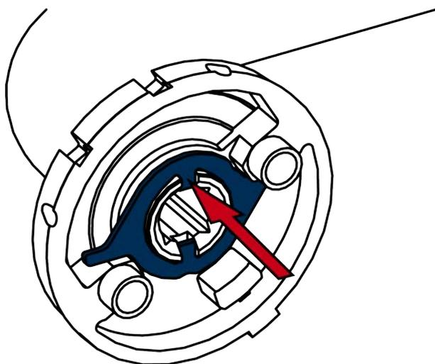
7. Appuyez la plaque à ressort d'un côté contre la plaquette adaptable de sorte que le ressort soit comprimé.
