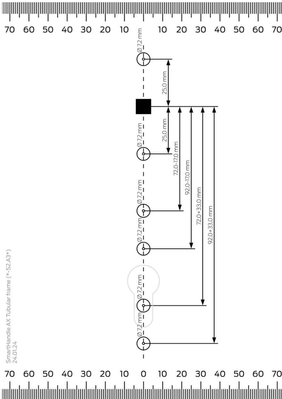
17.1.3.5 Gabarit de perçage pour variante A4.P11/A4.P1/A4.P2 (barres antipanique)
