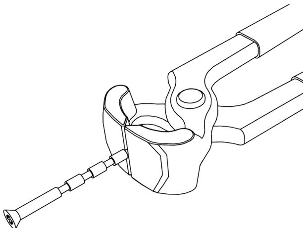
4. Pour carré de 7 mm : Insérez la douille d'adaptation sur le côté du carré avec broche.
