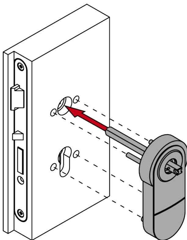
14. Vissez la base de la rosace sur l'ouverture du cylindre de fermeture à l'aide des vis L2 (PH2, couple : 1,1 Nm).
