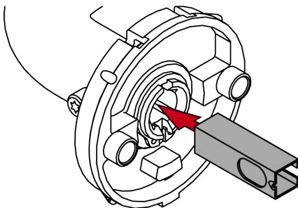
5. Déterminez le sens de rotation de votre béquille intérieure vu de l'intérieur : Sens horaire (Clockwise = CW) ou sens antihoraire (Counter-clockwise = CCW).
