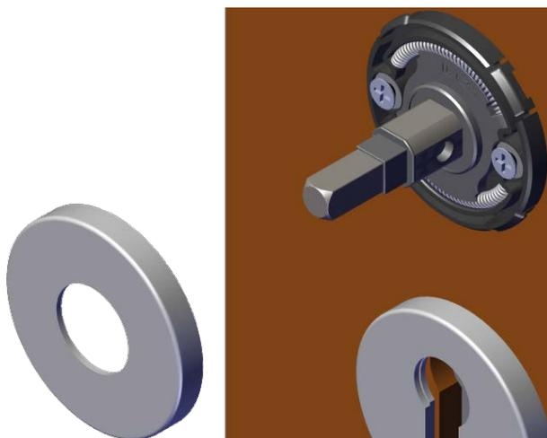
11. Enfichez la béquille intérieure FSB avec la vis sans tête prémontée sur le carré.
