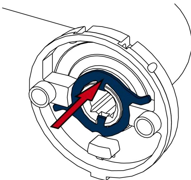
8. Appuyez la plaque à ressort d'un côté contre la plaquette adaptable de sorte que le ressort soit comprimé.
