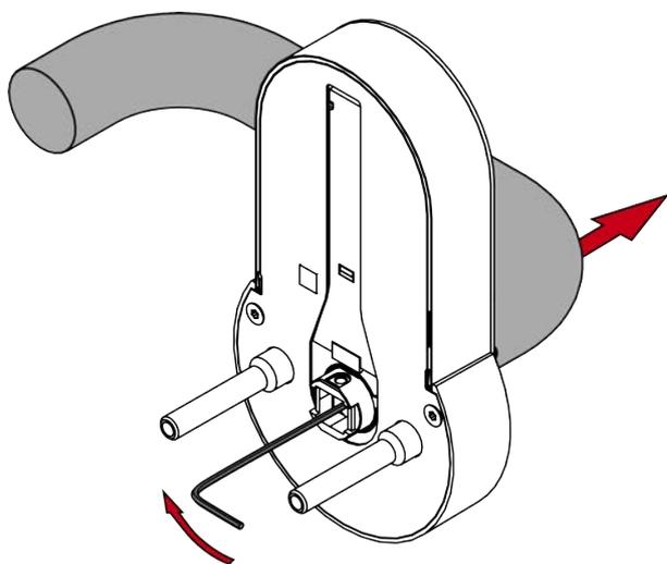
↳ La SI.SmartHandle AX est démontée.
