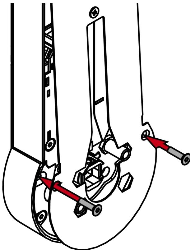
↳ Les écrous des boulons sont de nouveau fixés par l'arrière du SI.Smart-Handle AX.
