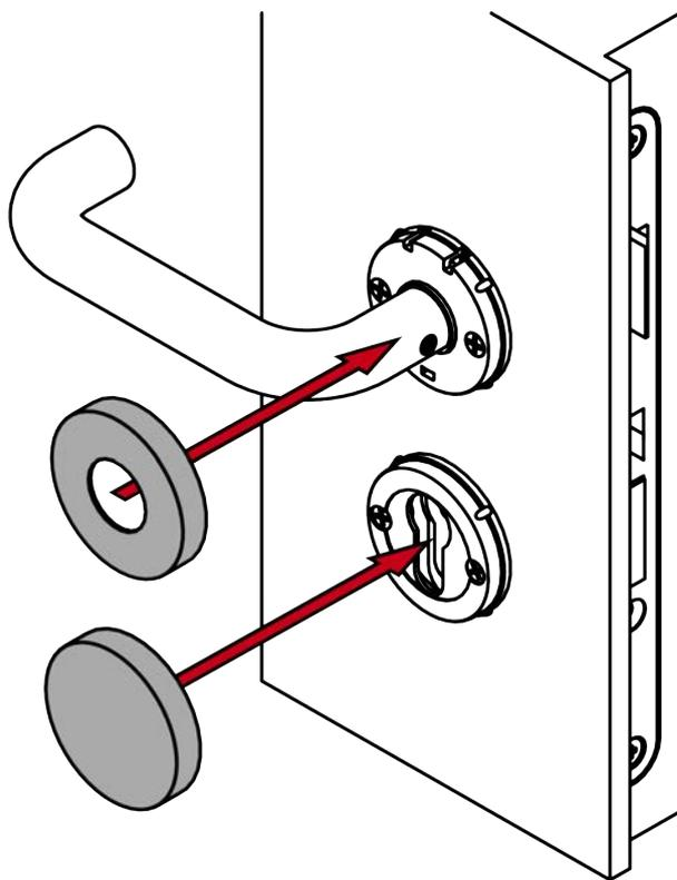
21. Sur le côté extérieur, insérez le blinde avec l'encoche vers le bas sur la base de la rosace.
