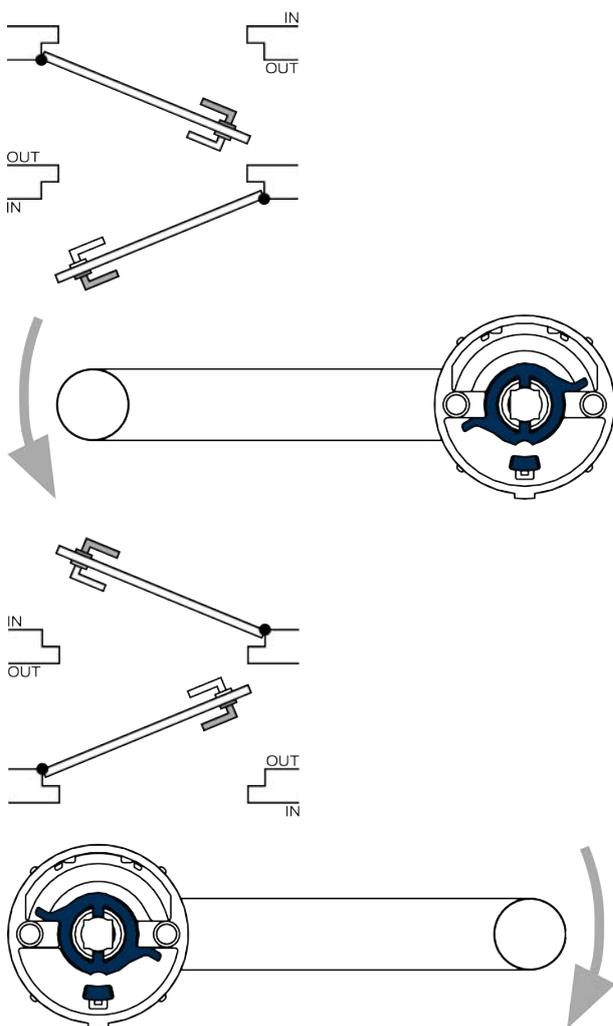
7. Insérez la plaquette adaptable dans la béquille intérieure.
