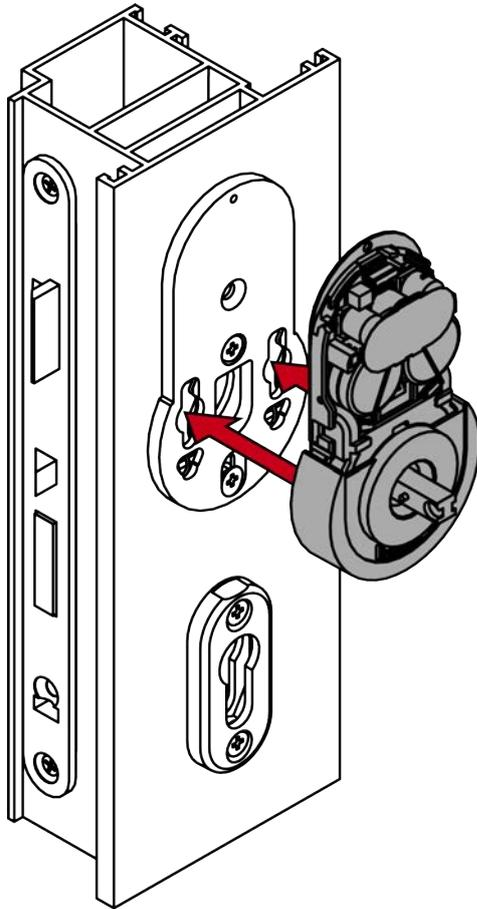
6. Poussez la ferrure vers le bas dans la plaque de montage jusqu'à la butée.
