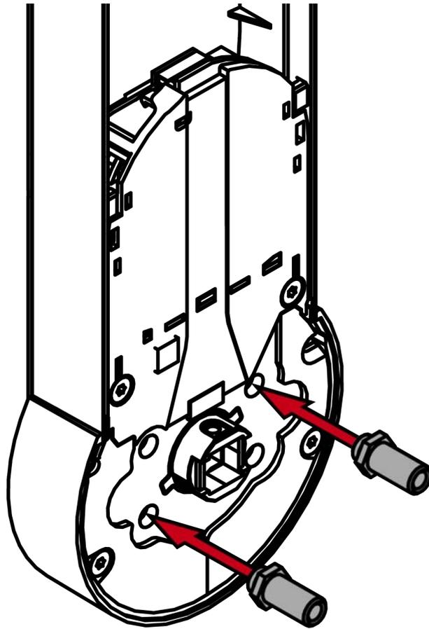
5. Revissez l'arrière du SI.SmartHandle AX (TX8, couple : 1,1 Nm).
