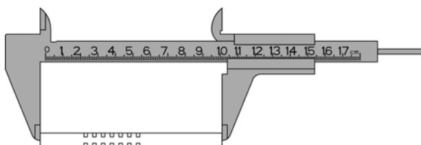
16. Déterminez le côté intérieur du carré (extrémité du carré jusqu'au milieu de la première rainure = 26 mm).
