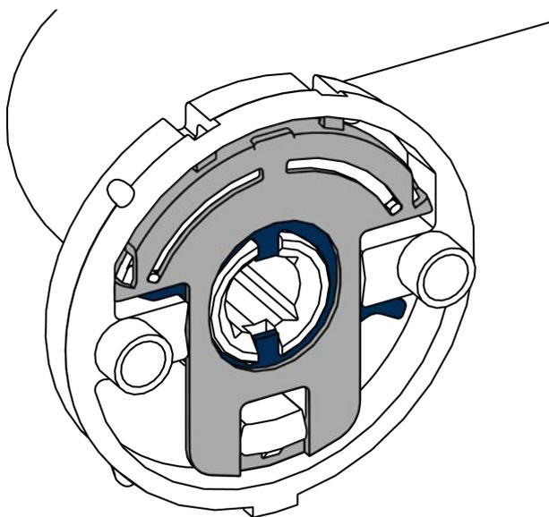
11. Pour carré de 7 mm : Insérez la douille d'adaptation sur le côté du carré avec broche.
