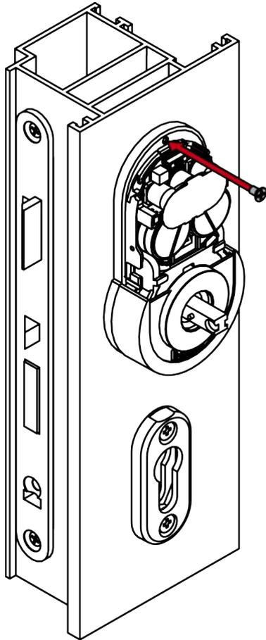
8. Insérez une blinde avec l'encoche vers le bas sur la base de la rosace.
