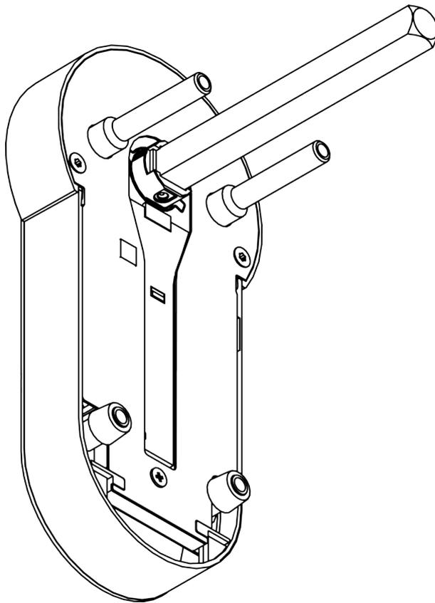
13. Pour carrés de 8,5 mm et 10 mm : Faites glisser la douille de l'adaptateur au centre du carré. À l'aide d'un pointeau et d'un marteau, faites un creux dans la douille de l'adaptateur pour l'empêcher de glisser.
