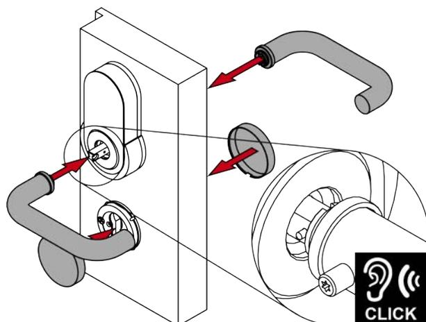
24. Vissez les vis sans tête des deux béquilles (TX15, couple de serrage : 5,0 Nm).
