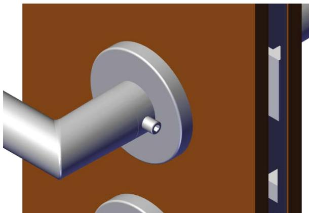
↳ La SI.SmartHandle AX est équipée d'une garniture à béquille FSB.
