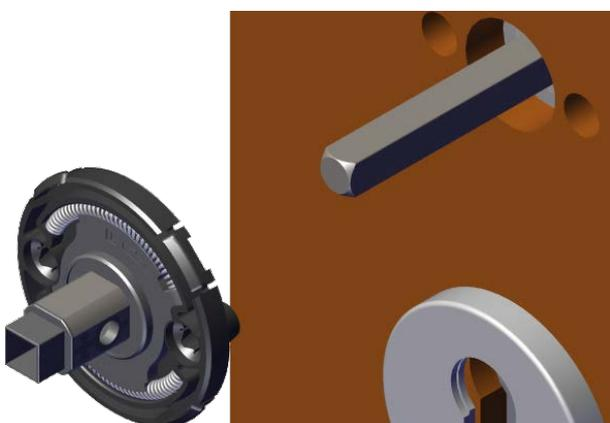
9. Vissez le palier FSB à l'aide des vis utilisées jusqu'à présent et des rondelles jointes.
