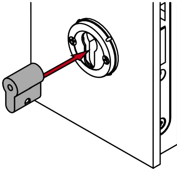
18. Pour FH : Vissez le cylindre borgne (PH2, couple de serrage : 1,1 Nm).
