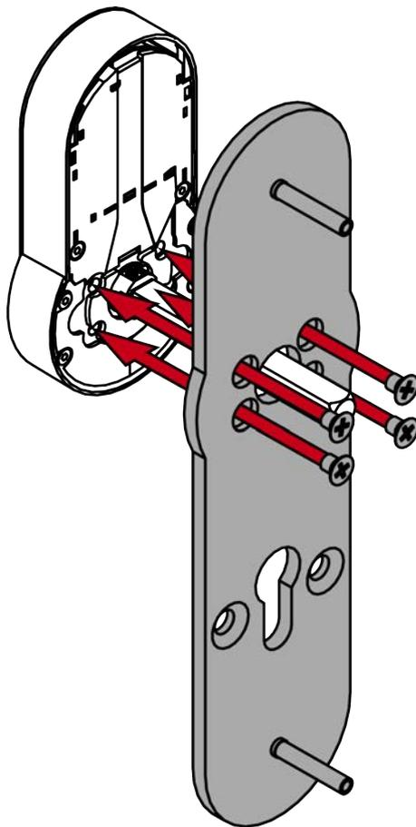
7. Maintenez les écrous à tête fraisée à l'aide de l'outil spécial et vissez la base de la rosace sur la plaque d'adaptation extérieure (PH2, couple : 1,1 Nm).
