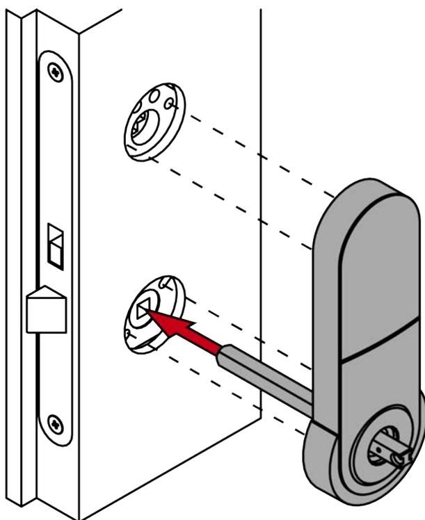
14. Vissez la base de la rosace avec les vis L1 (PH2, couple de serrage : 1,1 Nm).
