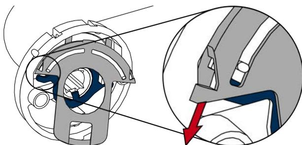
9. Accrochez simultanément les panetons de la plaque à ressort dans le logement de la béquille intérieure.
