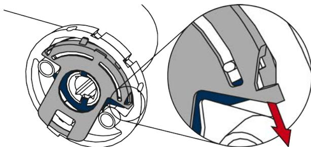
8. Accrochez simultanément les panetons de la plaque à ressort dans le logement de la béquille intérieure.
