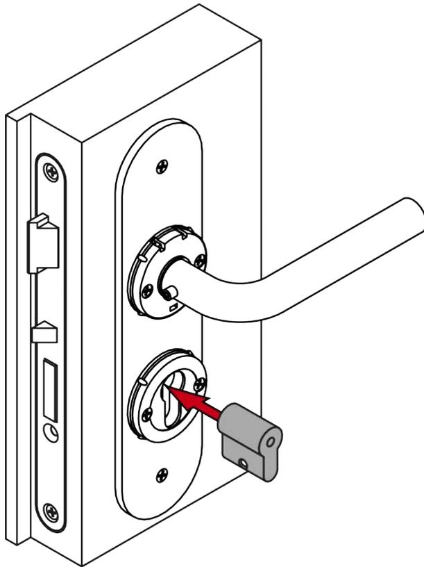
14. Pour FH : Vissez le cylindre borgne (PH2, couple de serrage : 1,1 Nm).
