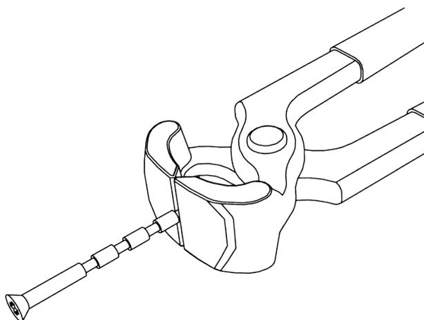
4. Pour carré de 7 mm : Placez la douille d'adaptation dans le logement carré de la béquille intérieure de manière à ce que l'évidement soit orienté vers la vis sans tête.
