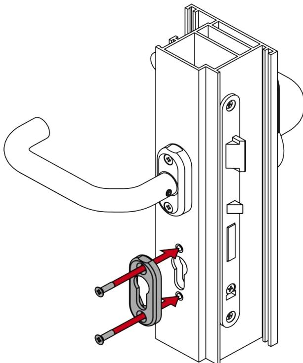
24. Vissez les vis sans tête des deux béquilles (TX15, couple de serrage : 5,0 Nm).
