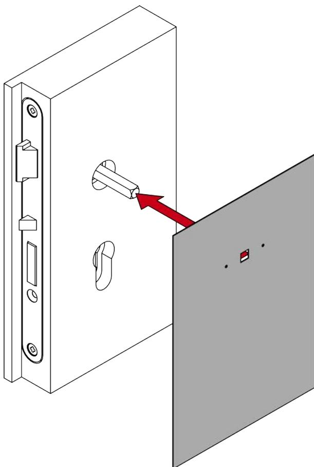
3. Alignez le gabarit de perçage verticalement à l'aide de l'échelle imprimée.
