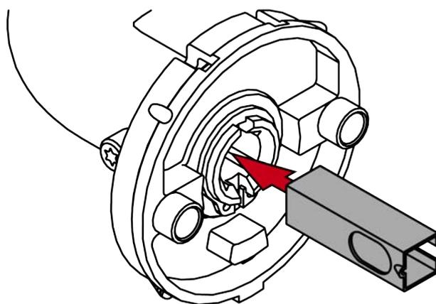
9. Maintenez les écrous à tête fraisée avec l'outil spécial et vissez la bécuille intérieure et la base de la rosace sur la plaque d'adaptation intérieure (PH2, couple : 1,1 Nm).
