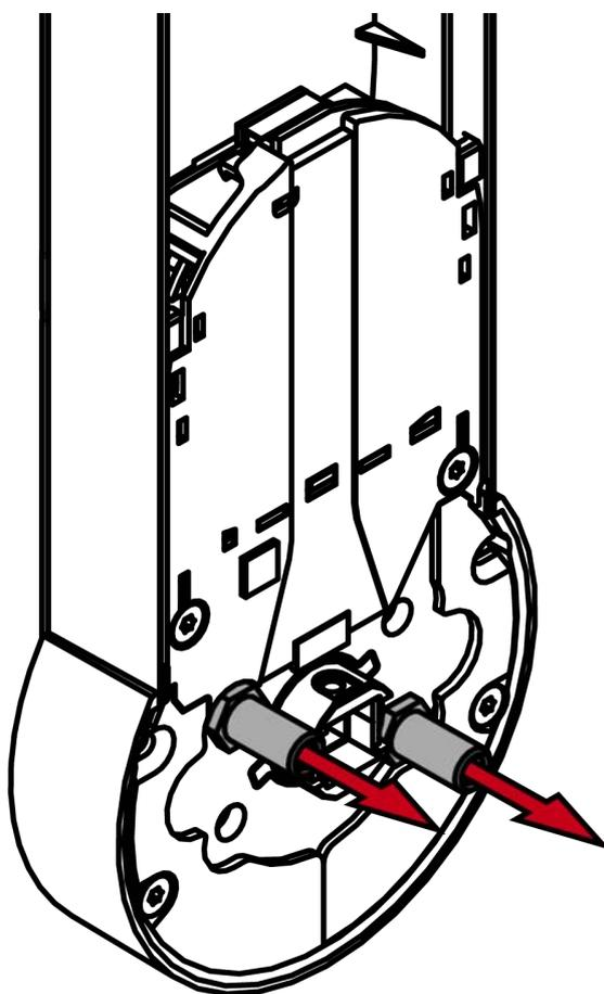
4. Revissez les écrous des boulons dans les nouvelles positions.
