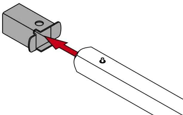
11. Pour carrés de 8,5 mm et 10 mm : Faites glisser la douille de l'adaptateur au centre du carré. À l'aide d'un pointeau et d'un marteau, faites un creux dans la douille de l'adaptateur pour l'empêcher de glisser.
