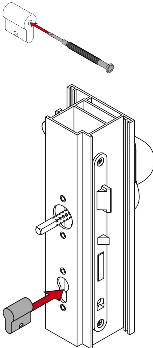
21. Pour FH : Vissez le cylindre borgne (PH2, couple de serrage : 1,1 Nm).
