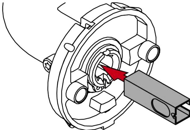
6. Déterminez le sens de rotation de votre béquille intérieure vu de l'intérieur : Sens horaire (Clockwise = CW) ou sens antihoraire (Counter-clockwise = CCW).
