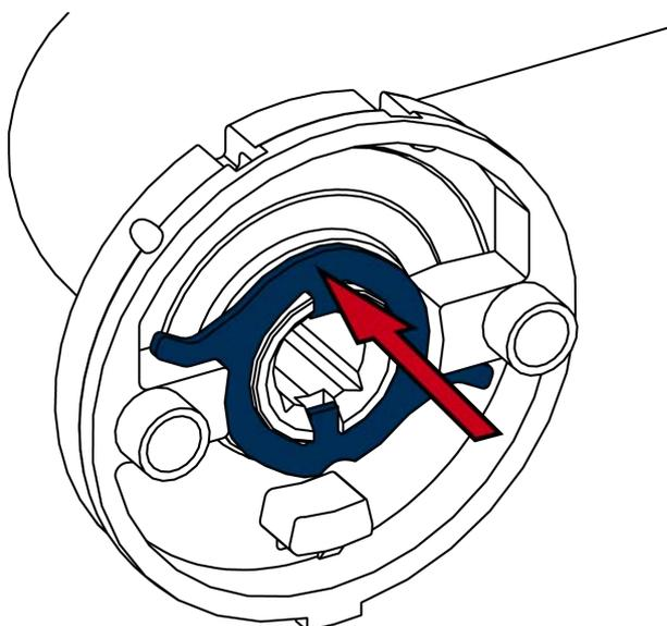
7. Appuyez la plaque à ressort d'un côté contre la plaquette adaptable de sorte que le ressort soit comprimé.
