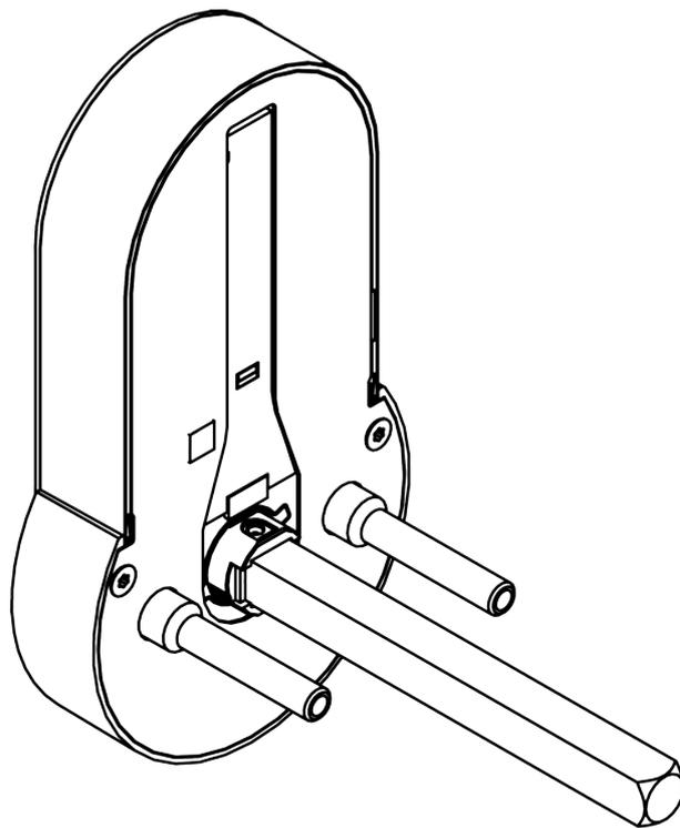
12. Pour carrés de 8,5 mm et 10 mm : Faites glisser la douille de l'adaptateur au centre du carré. À l'aide d'un pointeau et d'un marteau, faites un creux dans la douille de l'adaptateur pour l'empêcher de glisser.
