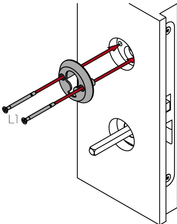
15. Pour les non-MO : Fixez la béquille intérieure à l'aide des vis L2 (PH2, couple 1,1 Nm).
