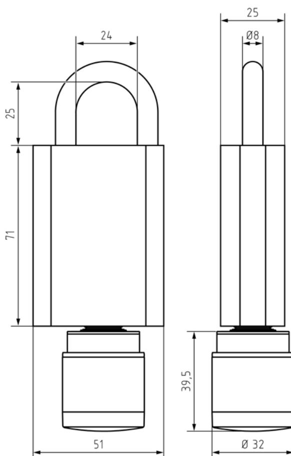
Anse d'un diamètre de 8 mm, d'une hauteur intérieure de 60 mm
