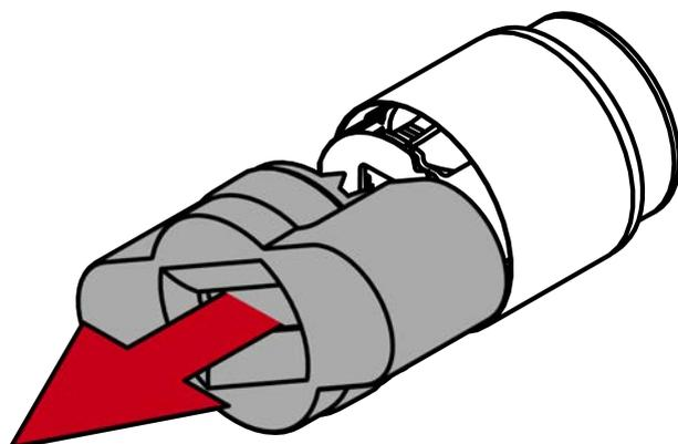
6. Poussez le bec de blocage vers l'intérieur et ouvrez le couvercle des piles.
