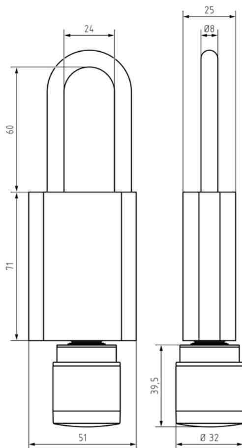
Anse d'un diamètre de 8 mm, d'une hauteur intérieure de 50 mm
