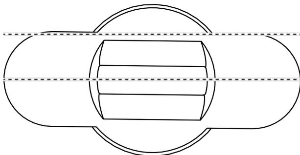
4. Tenez fermement l'outil spécial et le cache de la poignée, puis faites tourner les deux d'abord de 1 à 2° dans le sens des aiguilles d'une montre, puis dans le sens inverse.
