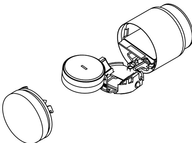
Le bouton électronique se compose de plusieurs éléments. Il se distingue du bouton mécanique par :
