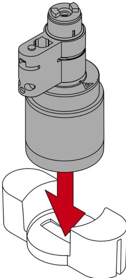
9. Placez la pièce centrale du demi-cylindre sur la moitié de cylindre préparée.
