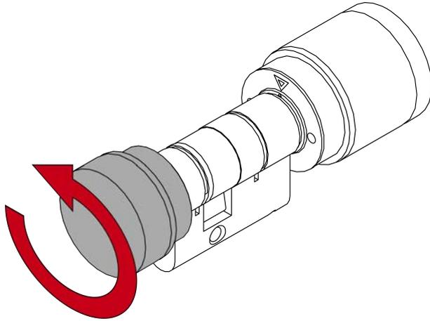
3. Insérez le SI Digital Glass Door Cylinder AX dans la porte.
