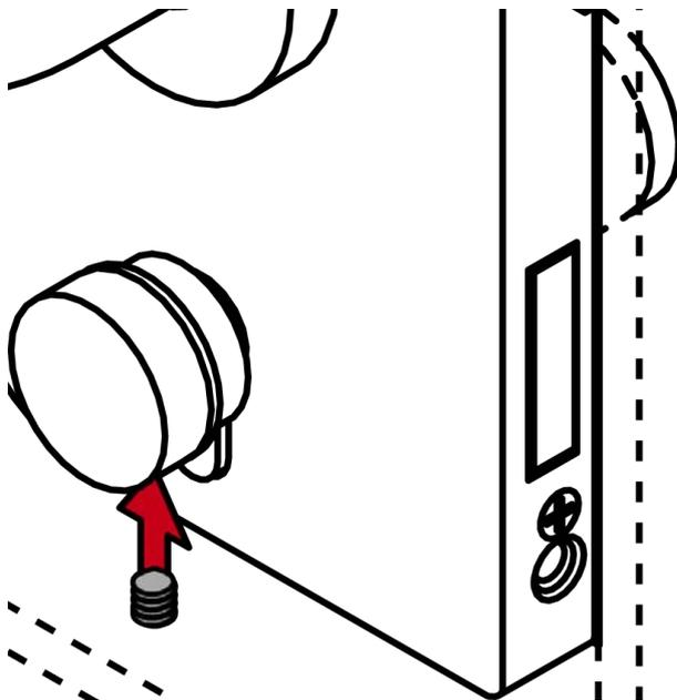
↳ Le SI Digital Glass Door Cylinder AX est monté.
