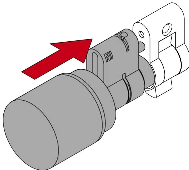
17. Remplacez le clip avec l'ergot en direction de la vis de maintien dans la fente du cylindre profilé et appuyez fermement sur le clip avec le pouce pour qu'il ne puisse plus tomber.
