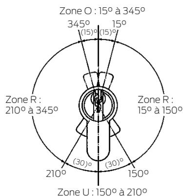
Pour ces portes/serrures encastrées, il faut utiliser un SI Digital Cylinder AX avec fonction antipanique (AP).
