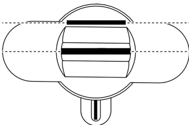
9. Tenez fermement l'outil spécial et le cache de la poignée, puis faites tourner les deux d'abord de 1 à 2° dans le sens des aiguilles d'une montre, puis dans le sens inverse.
