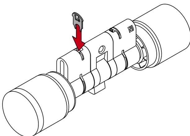
↳ Le panneton sur le SI Digital Cylinder AX est remplacé.
