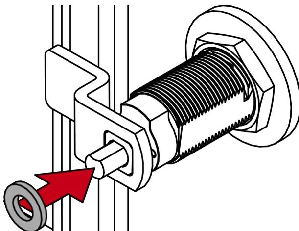
8. Vissez ensuite l'écrou hexagonal sur le levier (ouverture 10 mm).
