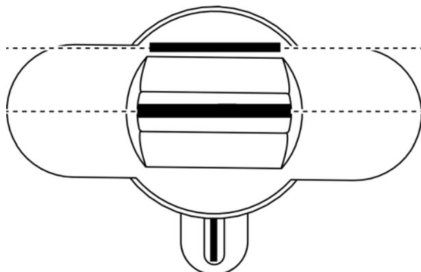
4. Tenez fermement l'outil spécial et le cache de la poignée, puis faites tourner les deux d'abord de 1 à 2° dans le sens des aiguilles d'une montre, puis dans le sens inverse.
