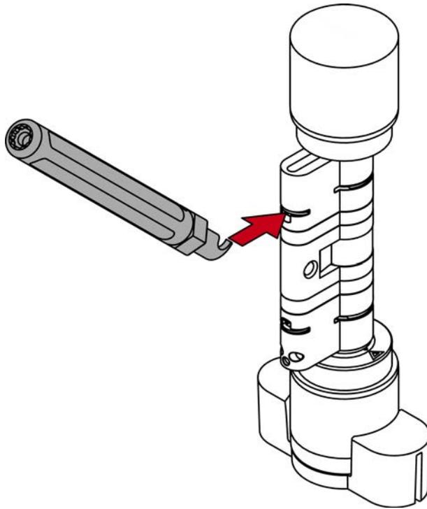
3. Faites levier pour séparer le clip du cylindre profilé en déplaçant le dispositif de levage au milieu du cylindre.
