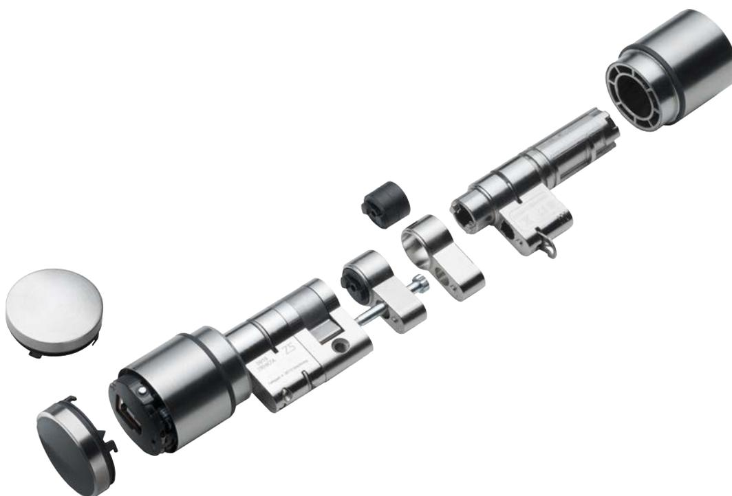
Le SI Digital Cylinder AX a une structure modulaire. Elle se compose toujours d'un profil de cylindre avec une protection contre le perçage et d'un actionneur intégré dans le rotor, ainsi que d'un bouton extérieur et en option d'un bouton intérieur.
