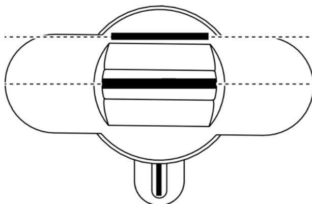
4. Tenez fermement l'outil spécial et le cache de la poignée, puis faites tourner les deux d'abord de 1 à 2° dans le sens des aiguilles d'une montre, puis dans le sens inverse.
