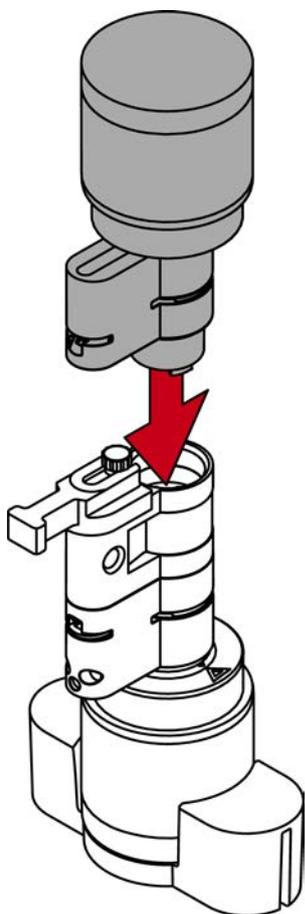
12. Remplacez le clip avec l'ergot en direction de la vis de maintien dans la fente du cylindre profilé.
