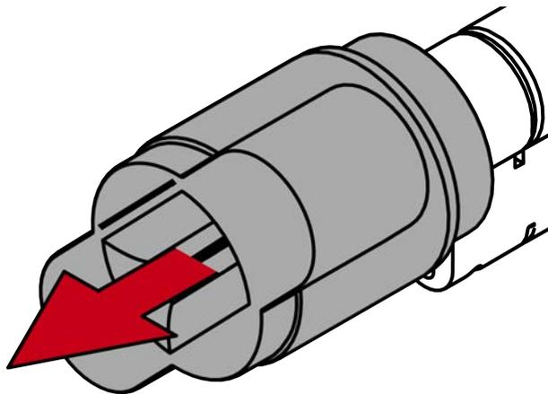
↳ Le bouton mécanique est démonté.
