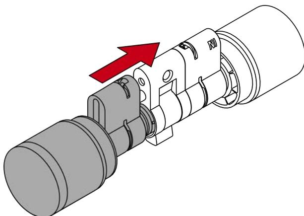
24. Remplacez le clip avec l'ergot en direction de la vis de maintien dans la fente du cylindre profilé et appuyez fermement sur le clip avec le pouce pour qu'il ne puisse plus tomber.
