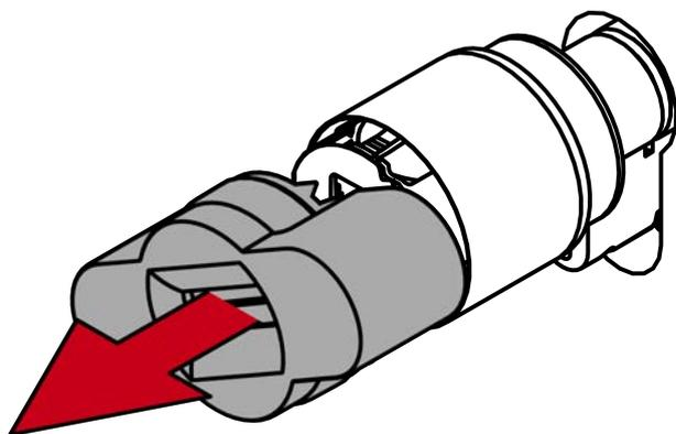
6. Enfoncez la clé six pans dans l'orifice prévu à cet effet jusqu'en butée.
