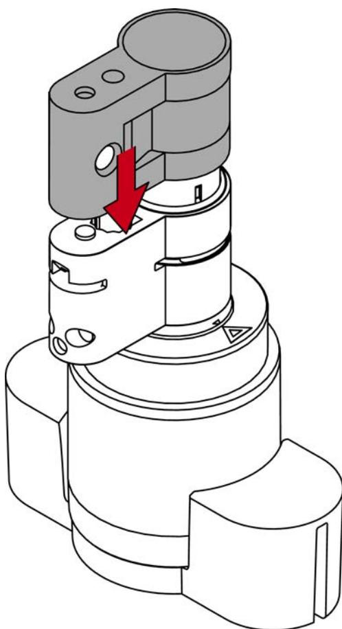
12. Remplacez le clip avec l'ergot en direction de la vis de maintien dans la fente du cylindre profilé.
