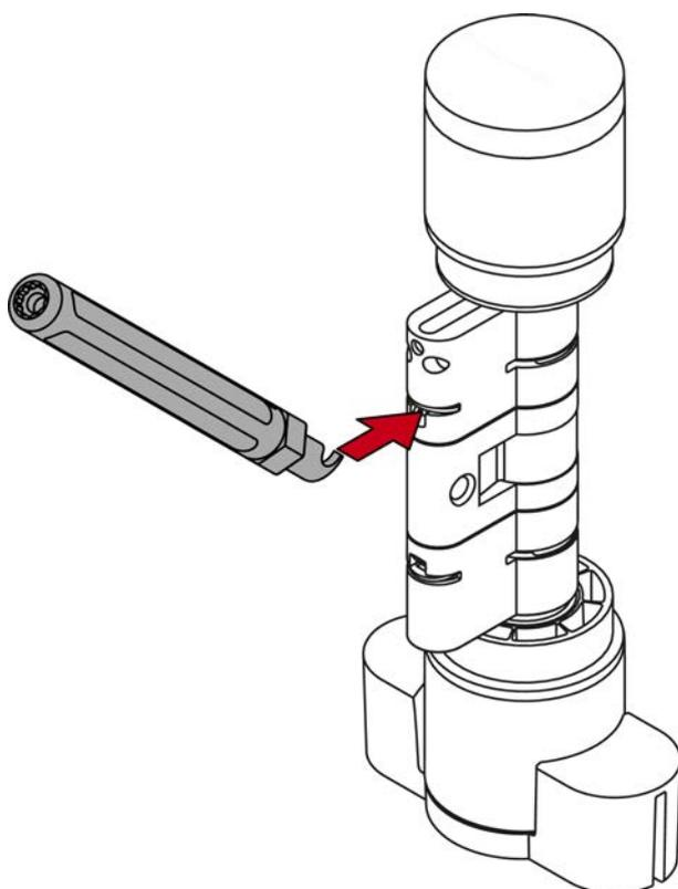
3. Faites levier pour séparer le clip du cylindre profilé en déplaçant le dispositif de levage au milieu du cylindre.
