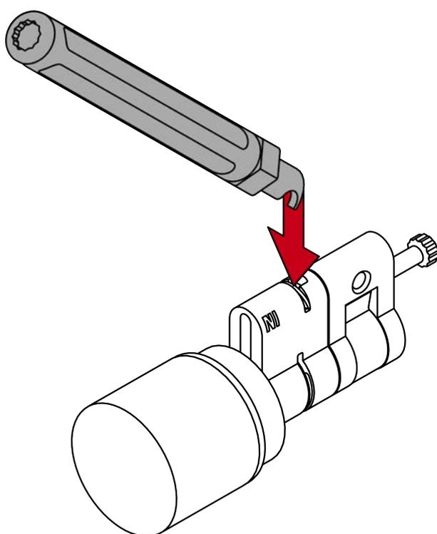
7. Faites levier pour séparer le clip du cylindre profilé en déplaçant la clé de levage au milieu du cylindre.
