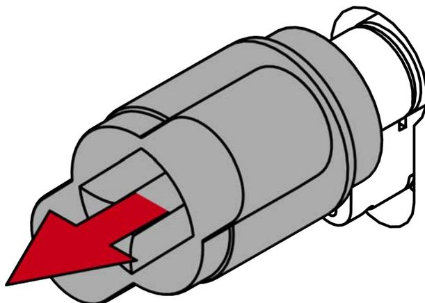
↳ La poignée mécanique est démontée.
