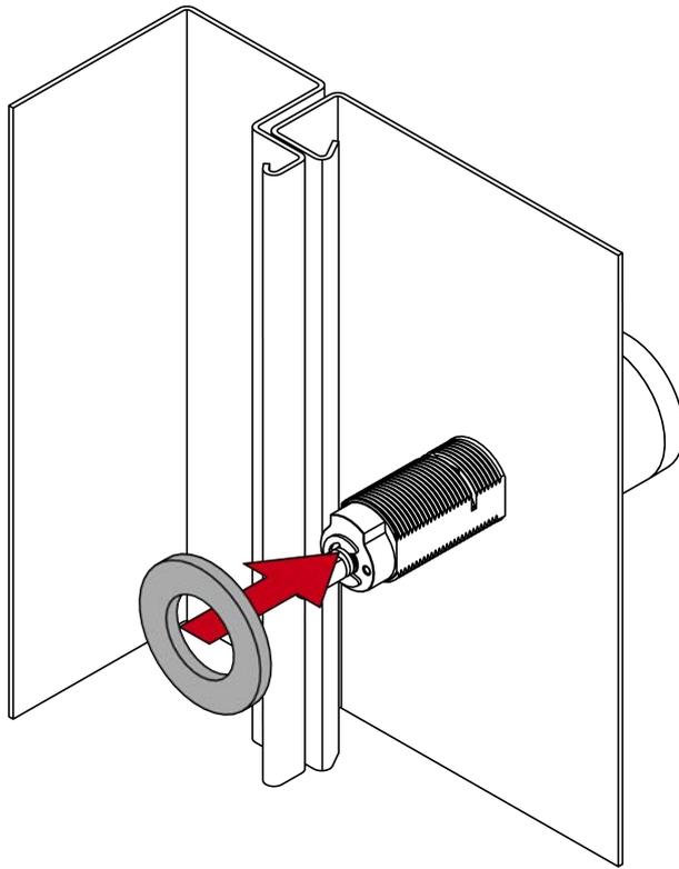
3. Insérez l'écrou sur le profil du cylindre et vissez-le fermement (ouverture 22 mm).
