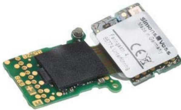
Les piles du SI Digital Cylinder AX alimentent ensuite également le nœud réseau en énergie. Après l'assemblage, une broche à ressort entre en contact avec le capuchon du bouton de lecture pour communiquer sans fil comme avec une antenne.
