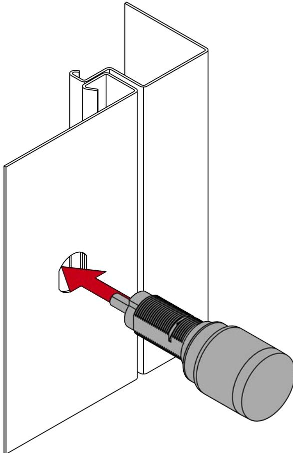
2. Placez la grande rondelle de calage ronde sur le profil du cylindre de manière à ce qu'elle repose à plat sur la face intérieure de la porte du casier.
