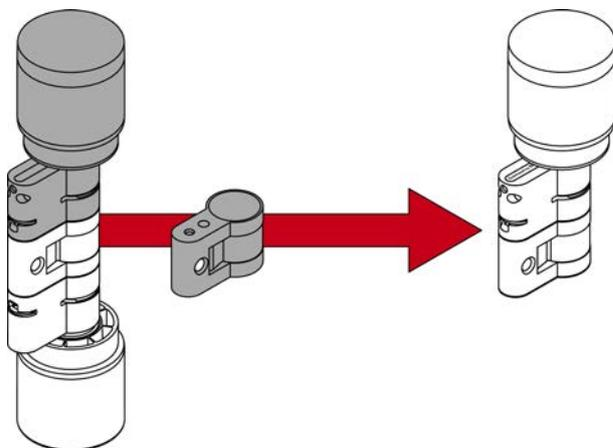
Vous pouvez assembler un demi-cylindre à partir d'un cylindre confort AX ou d'un cylindre à rotation libre à l'aide d'une pièce centrale.
