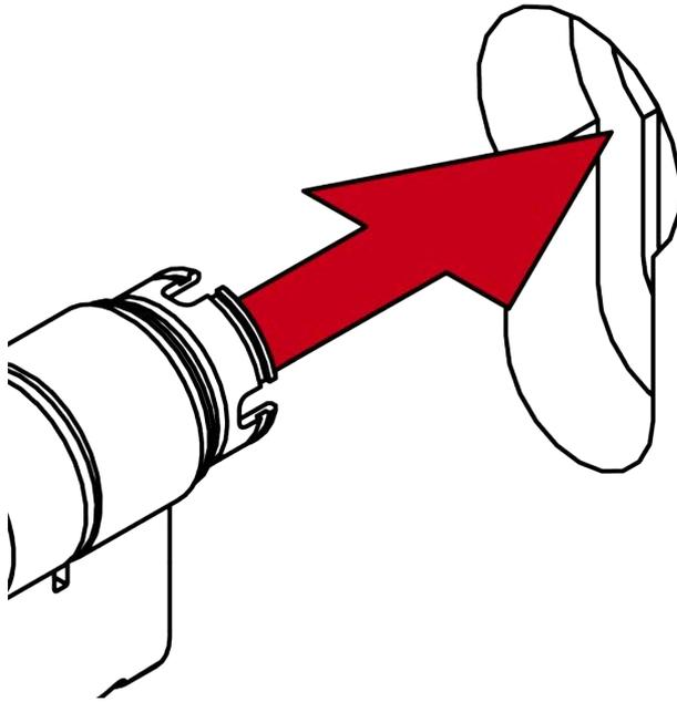
↳ Le SI Digital Cylinder AX est positionné dans la serrure encastrée.
