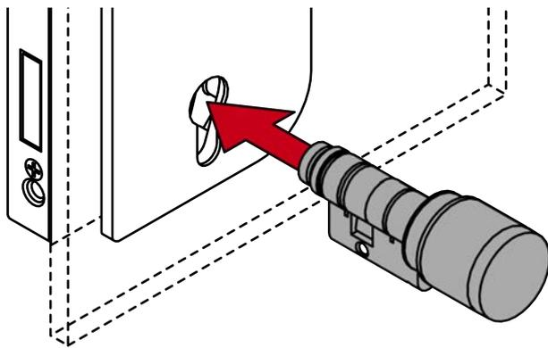
4. Vissez le SI Digital Glass Door Cylinder AX avec la vis de maintien (PH2).
