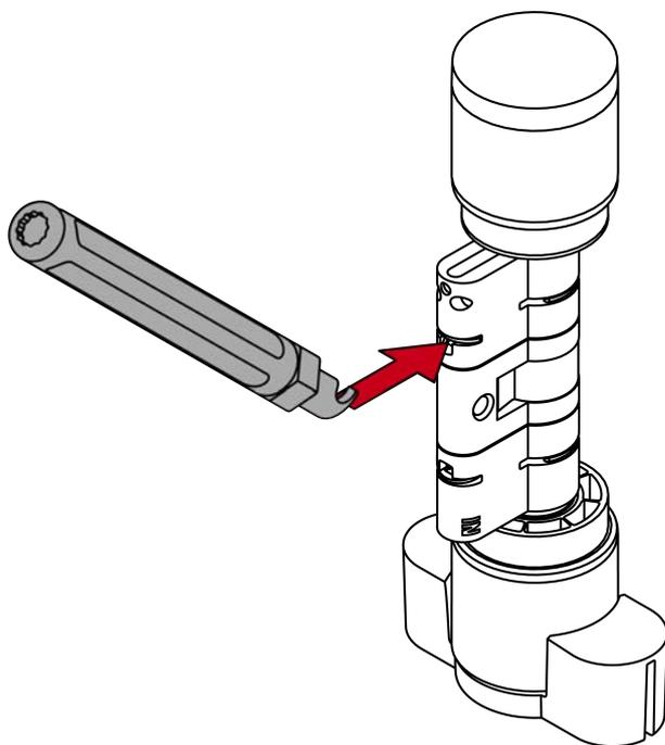
3. Faites lever pour séparer le clip du cylindre profilé en déplaçant la clé de levage au milieu du cylindre.
