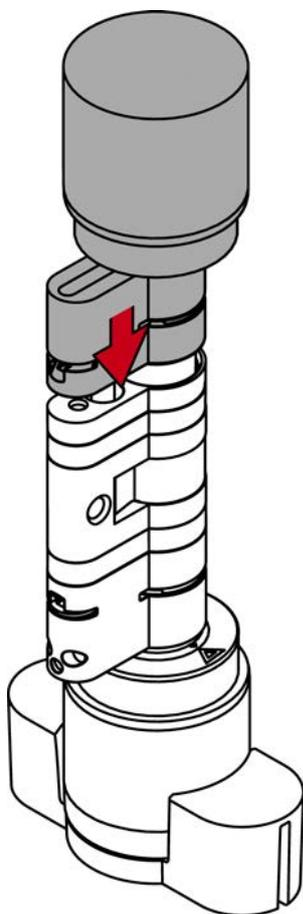
14. Remplacez le clip avec l'ergot en direction de la vis de maintien dans la fente du cylindre profilé et appuyez fermement sur le clip avec le pouce pour qu'il ne puisse plus tomber.
