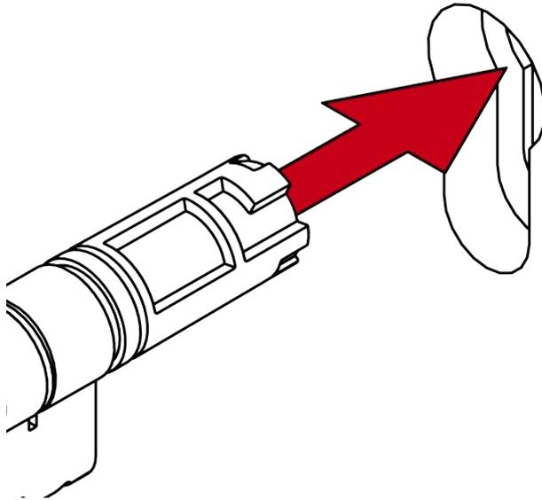
↳ Le SI Digital Cylinder AX est positionné dans la serrure encastrée.
