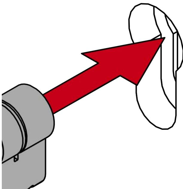
11. Vissez le SI Digital Cylinder AX avec la vis de maintien.
