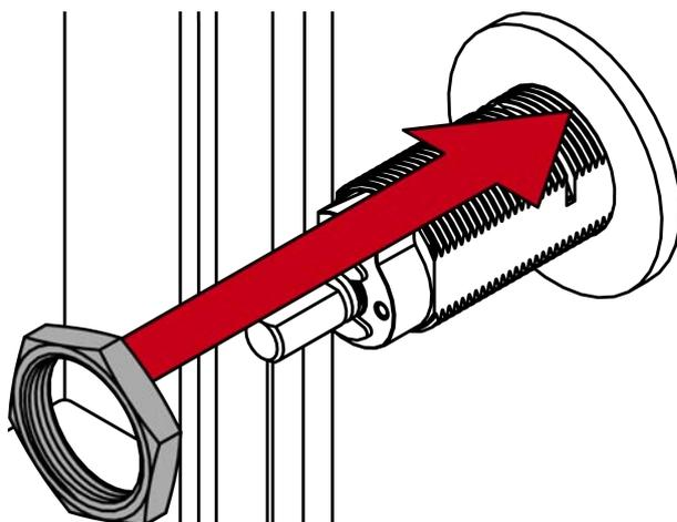
4. Placez la petite rondelle de calage sur l'extrémité du profil du cylindre.
