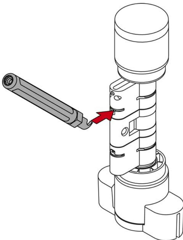
8. Faites levier pour séparer le clip du cylindre profilé en déplaçant le dispositif de levage au milieu du cylindre.
