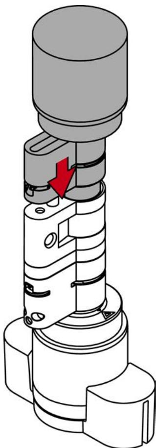
14. Remplacez le clip avec l'ergot en direction de la vis de maintien dans la fente du cylindre profilé.
