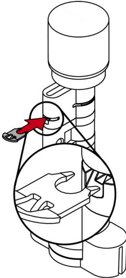
15. Placez le cylindre dans le bloc de serrage de manière à ce que le cylindre profilé et le bouton affleurent dans les évidements.
