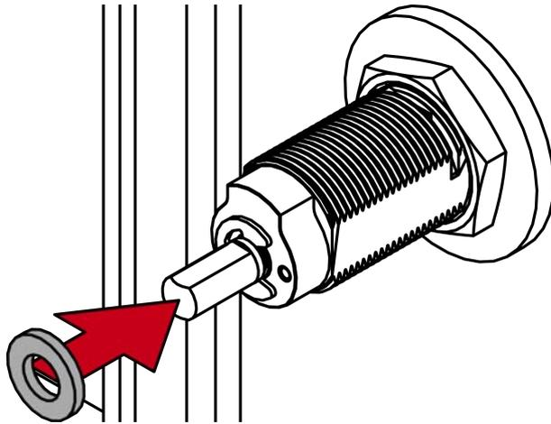
5. Insérez la douille carrée sur la petite rondelle de calage.
