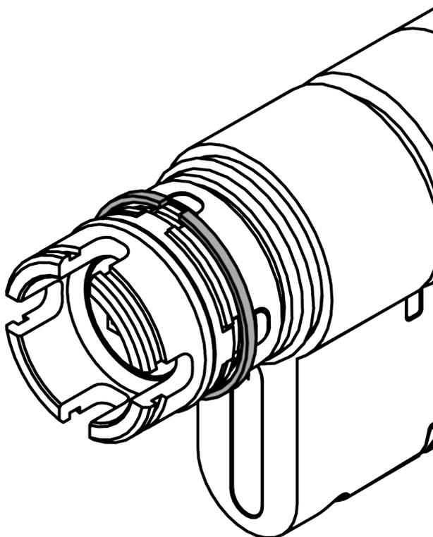
4. Poussez la bague de fixation avec le plus petit diamètre en direction du panneton jusqu'en butée contre le logement du bouton.
