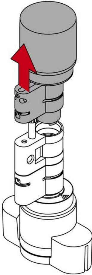
↳ La première moitié de cylindre est préparée avec pièce centrale et dispositif d'entraînement.
