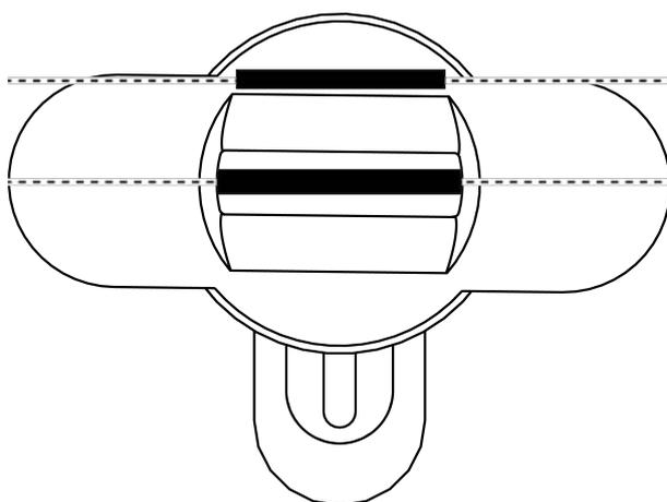
4. Tenez fermement l'outil spécial et le cache de la poignée, puis faites tourner les deux d'abord de 1 à 2° dans le sens des aiguilles d'une montre, puis dans le sens inverse.
