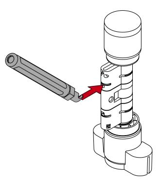
3. Faites levier pour séparer le clip du cylindre profilé en déplaçant la clé de levage au milieu du cylindre.
