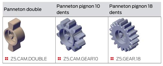
Vous trouverez les schémas cotés au chapitre Dimensions des pannetons, pour le montage, voir *Remplacement du panneton* [\* 62].
