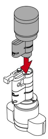
12. Replacez le clip avec l'ergot en direction de la vis de maintien dans la fente du cylindre profilé.
