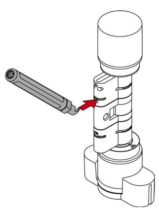
3. Faites levier pour séparer le clip du cylindre profilé en déplaçant le dispositif de levage au milieu du cylindre.
