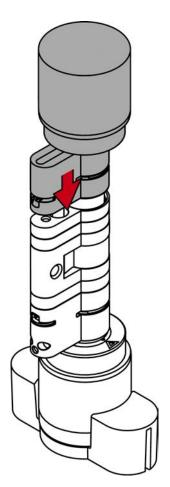
14. Replacez le clip avec l'ergot en direction de la vis de maintien dans la fente du cylindre profilé et appuyez fermement sur le clip avec le pouce pour qu'il ne puisse plus tomber.
