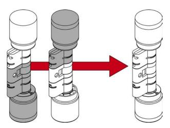
Vous pouvez assembler deux cylindres confort AX pour former un cylindre AX à rotation libre.
