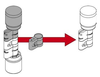
Vous pouvez assembler un demi-cylindre à partir d'un cylindre confort AX ou d'un cylindre à rotation libre à l'aide d'une pièce centrale.
