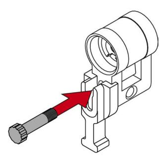
8. Placez la moitié de cylindre préparée dans l'outil de montage de poignée.
