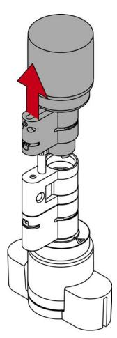
→ La première moitié de cylindre est préparée avec pièce centrale et dispositif d'entraînement.
