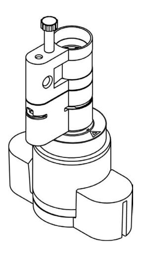
6. Placez le deuxième cylindre confort AX avec le bouton électronique vers le haut dans l'outil de montage de poignée.
