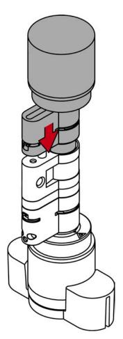
14. Replacez le clip avec l'ergot en direction de la vis de maintien dans la fente du cylindre profilé.
