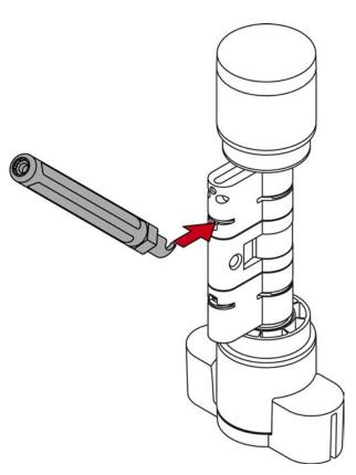
8. Faites levier pour séparer le clip du cylindre profilé en déplaçant le dispositif de levage au milieu du cylindre.
