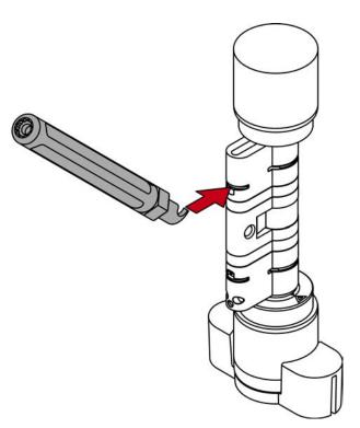
3. Faites levier pour séparer le clip du cylindre profilé en déplaçant le dispositif de levage au milieu du cylindre.
