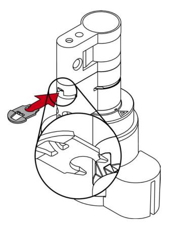
13. Placez le cylindre dans le bloc de serrage de manière à ce que le cylindre profilé et le bouton affleurent dans les évidements.
