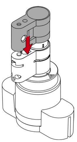
12. Replacez le clip avec l'ergot en direction de la vis de maintien dans la fente du cylindre profilé.
