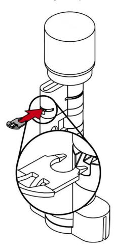
15. Placez le cylindre dans le bloc de serrage de manière à ce que le cylindre profilé et le bouton affleurent dans les évidements.
