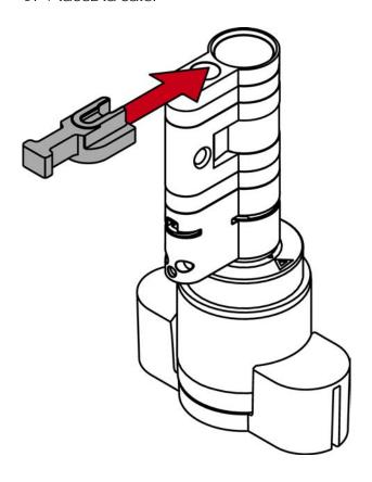
10. Vissez à l'aide de la clé de levage une tige d'extension adaptée jusqu'à ce qu'elle soit en contact avec la cale.
