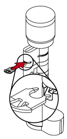
13. Placez le cylindre dans le bloc de serrage de manière à ce que le cylindre profilé et le bouton affleurent dans les évidements.
