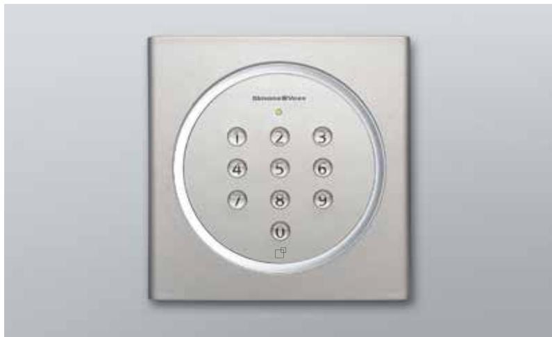
Das ultraflache PinCode-Terminal aus silberfarbenem ABS-Kunststoff lässt sich kabelfrei im Innen- und Außenbereich anbringen. Es ist Aufputz montierbar – wahlweise auch auf Glas. Die Lebensdauer der Batterien beträgt bis zu 50.000 Betätigungen oder bis zu fünf Jahre Standby bei Wireless Online. Das mit dem IF-Product-Design-Award ausgezeichnete digitale PinCode-Terminal SmartIntego funktioniert zuverlässig in einem Temperaturbereich von  $-25\text{ °C}$  bis  $+65\text{ °C}$ .
