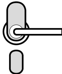
**A3** pour portes à encadrement tubulaire avec rosaces ovales (gabarit de perçage de 50 mm) – Largeur de profilé min. 65 mm
